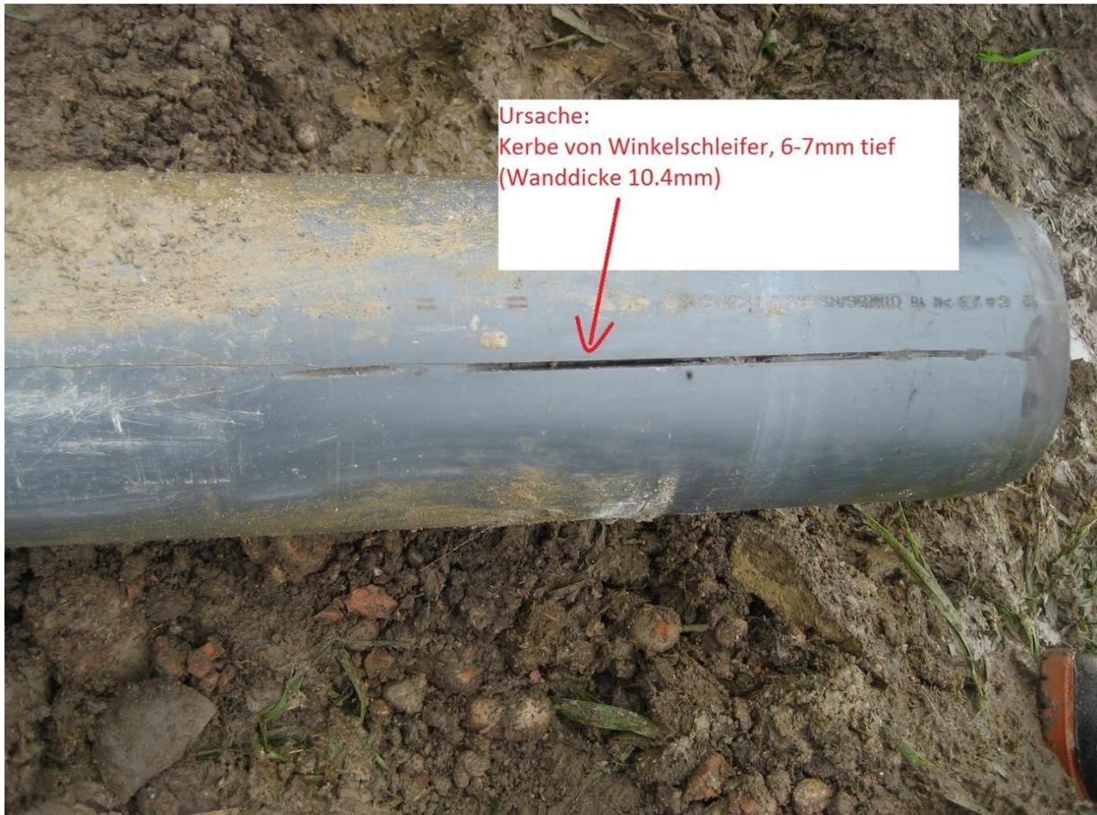
In diesem Bereich wurden zwei Bauetappen zusammengeschlossen. Zirka 4m Rohr wurden mit einer Überschiebemuffe eingepasst.
